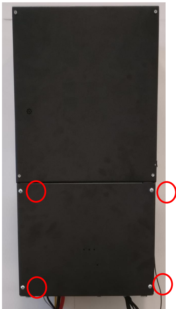
Figura 83 – Ripristino coperchio morsettiera ATM-BOX
