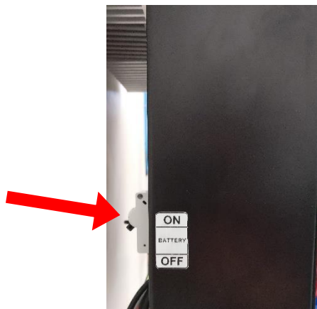
Figura 35 - Posizione in cui si deve trovare l'interruttore sul retro dell'inverter
